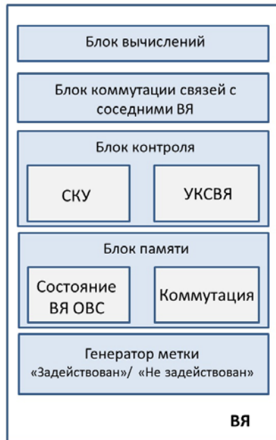
Рис. 13. Функциональные блоки ВЯ регенеративной ОВС
