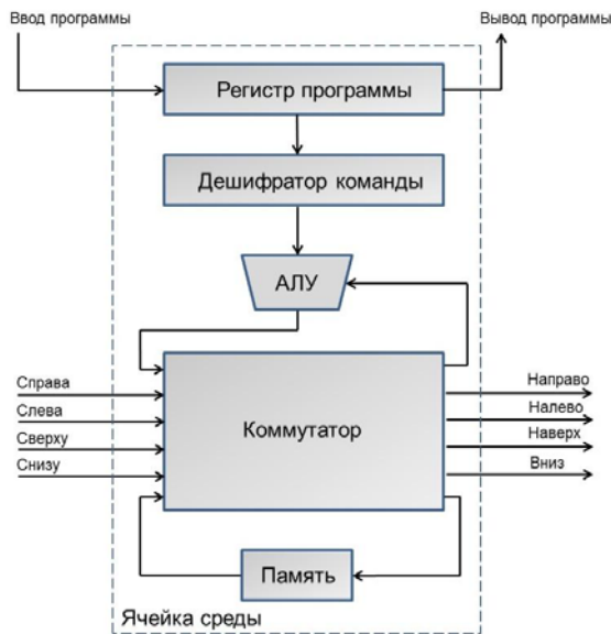
Рис. 11. Структура вычислительной ячейки ОВС
