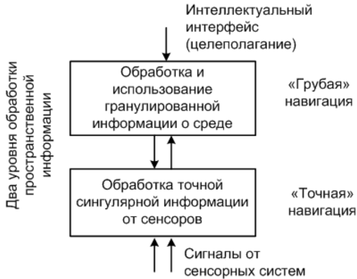
Иерархическая схема информационного взаимодействия мобильного когнитивного робота со средой
